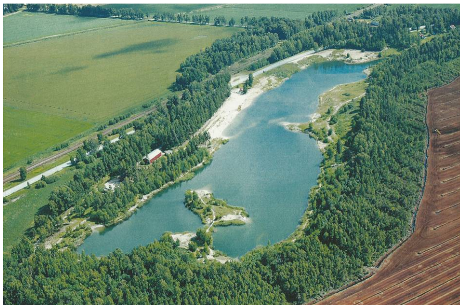
Täktsjön efter utförd efterbehandling. Foto: Bergslagsbild AB
