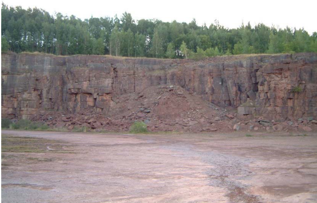
Lämnad bergsbrant med uppbyggd taluskon i efterbehandlad täkt för brytning av kalk till cementtillverkning. Foto: Länsstyrelsen i Västra Götalands län.
