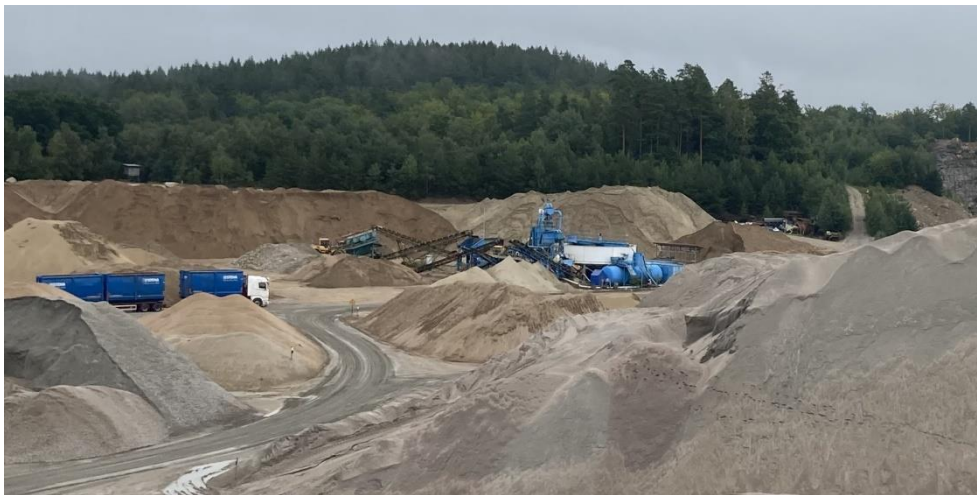
Berg- och grustäkt. Anläggning med kubiseringsdel och tillhörande våtsikt. Fotograf: Jens Artin
