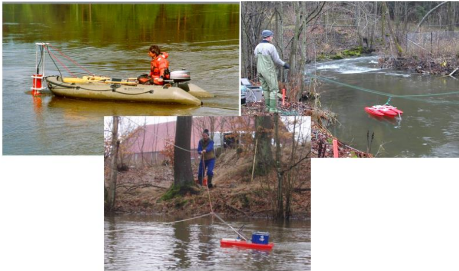
Figur 7 Mätmetoder för att registrera vattenhastigheterna i olika sektioner av vattendraget. En båt används ofta för mätningar i större vattendrag medan en lina ofta används i mindre vattendrag. Foto: SMHI
