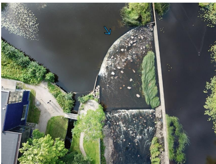
Figur 11 Åtgärder i form av trösklar och utläggning av sten för att underlätta fiskvandring har genomförts i Gävleån vid Gävle konsterhus. Foto: Länsstyrelsen i Västernorrlands län.
