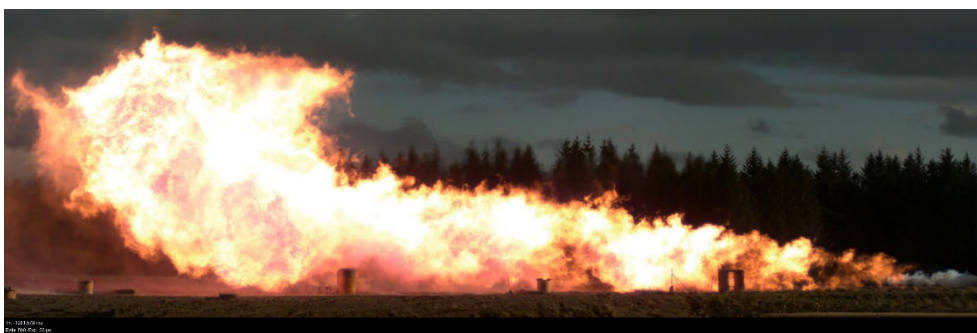
Figur 6: Storskalig jetflamma av kolväte från experiment utförd av DNV's Spadeadam Research and Development Facility. Copyright © 2020, DNV AS. All rights reserved.
