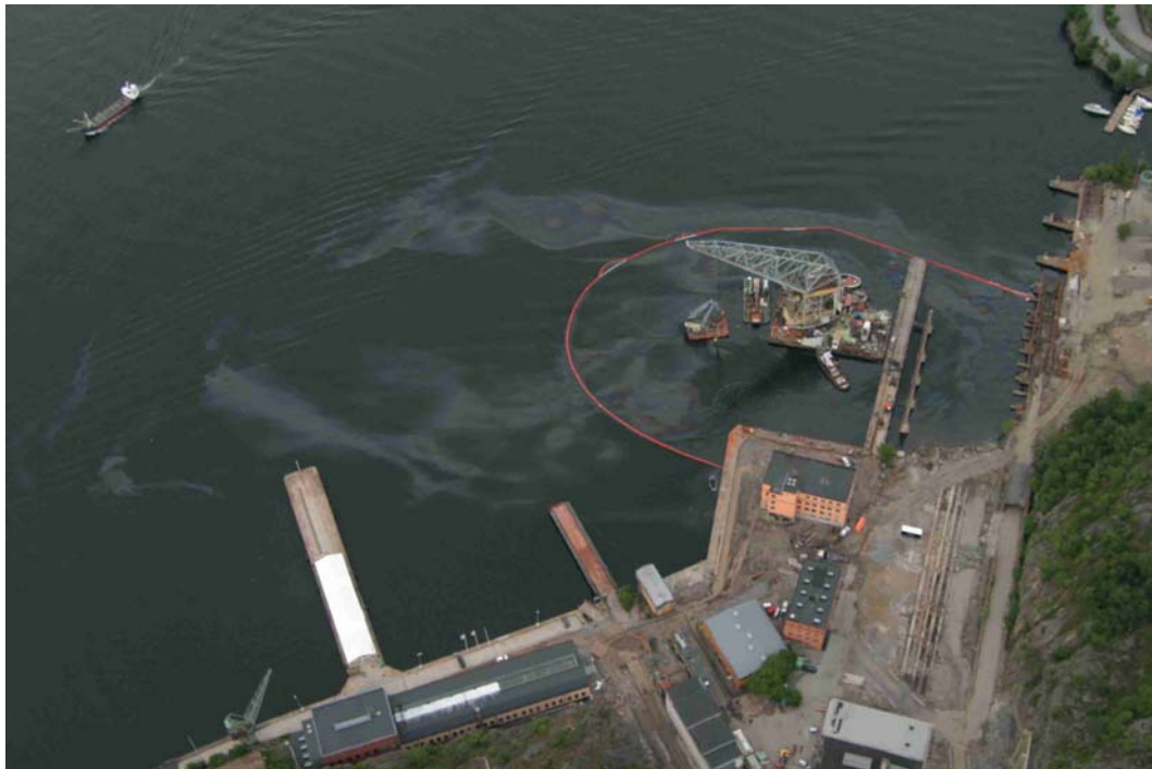
Bild 6. Fotografiet visar ett exempel på när läns och geotextil inte fungerar tillfredställande och oljeföroreningar sprids utanför skyddsskärmen. Fotograferat av Kustbevakningen.
