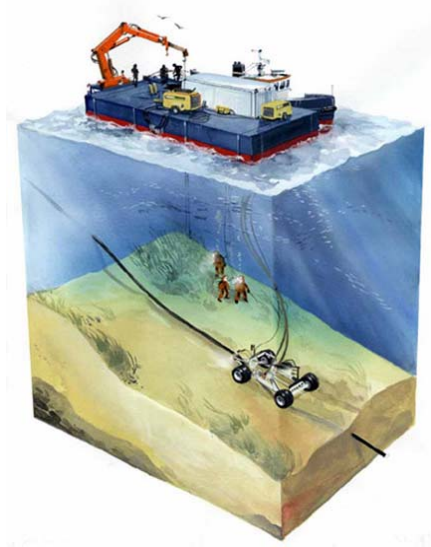
Bild 4-5. Dykarbaserat respektive fjärrstyrt spolsystem.
